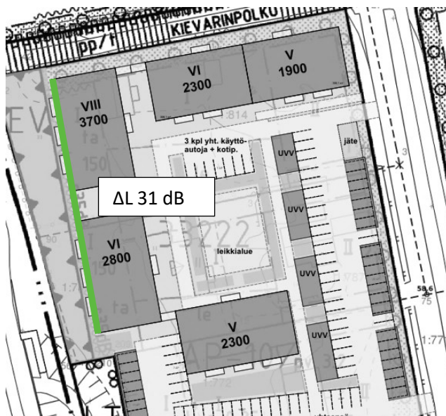
Kuva 3. Suositus julkisivuille annettavasta äänitasoero vaatimuksesta, kun \Delta L > 30 dB.
